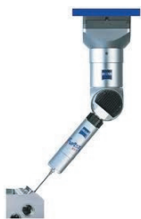
Zeiss VAST XXXT 3 mit RDS Dreh-Schwenkgelenk für 20.736 Winkelpositionen MPE-E0 = 1,6 + L/350 µm für Einzelpunkte und Scanning
