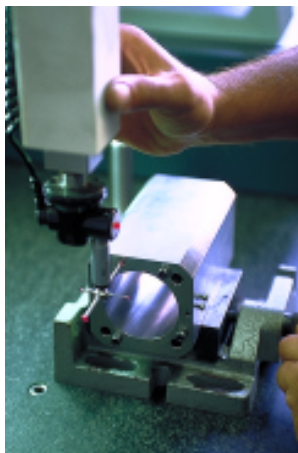
Masskontrolle auf einer 3D-Koordinaten- Messmaschine
