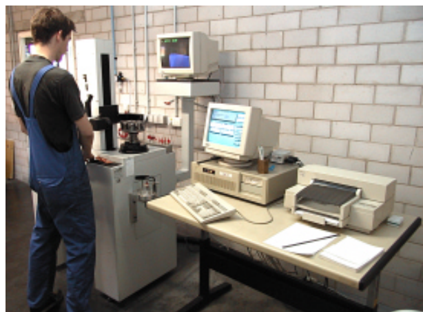
Werkzeugvermessung mit digitaler Bild- verarbeitung
